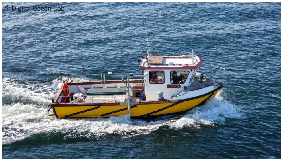
Bild (1): Im Digital Ocean Lab im Einsatz: Industriepartner nutzen das Survey-Boot mit dem Multibeam-Sonar, um ihre Messtechnik zu entwickeln und zu verbessern. (Quelle: Patrick Suhrbier - Digital Ocean Lab)
