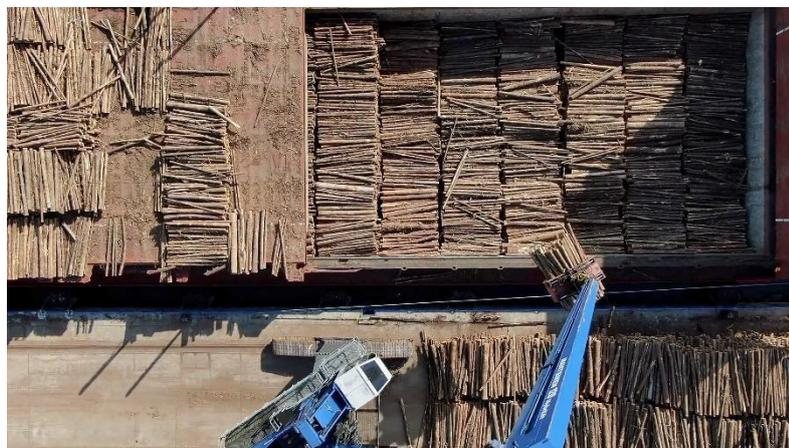
Bilder: Holzverladevorgang am Rostocker Fracht- und Fischereihafen: Ein akustisches Warnsystem des Fraunhofer IGD soll zukünftig den Dispatcher in der Hafenagentur informieren, wenn Ladung in die Fahrrinne zu geraten droht. (© Fraunhofer IGD)
