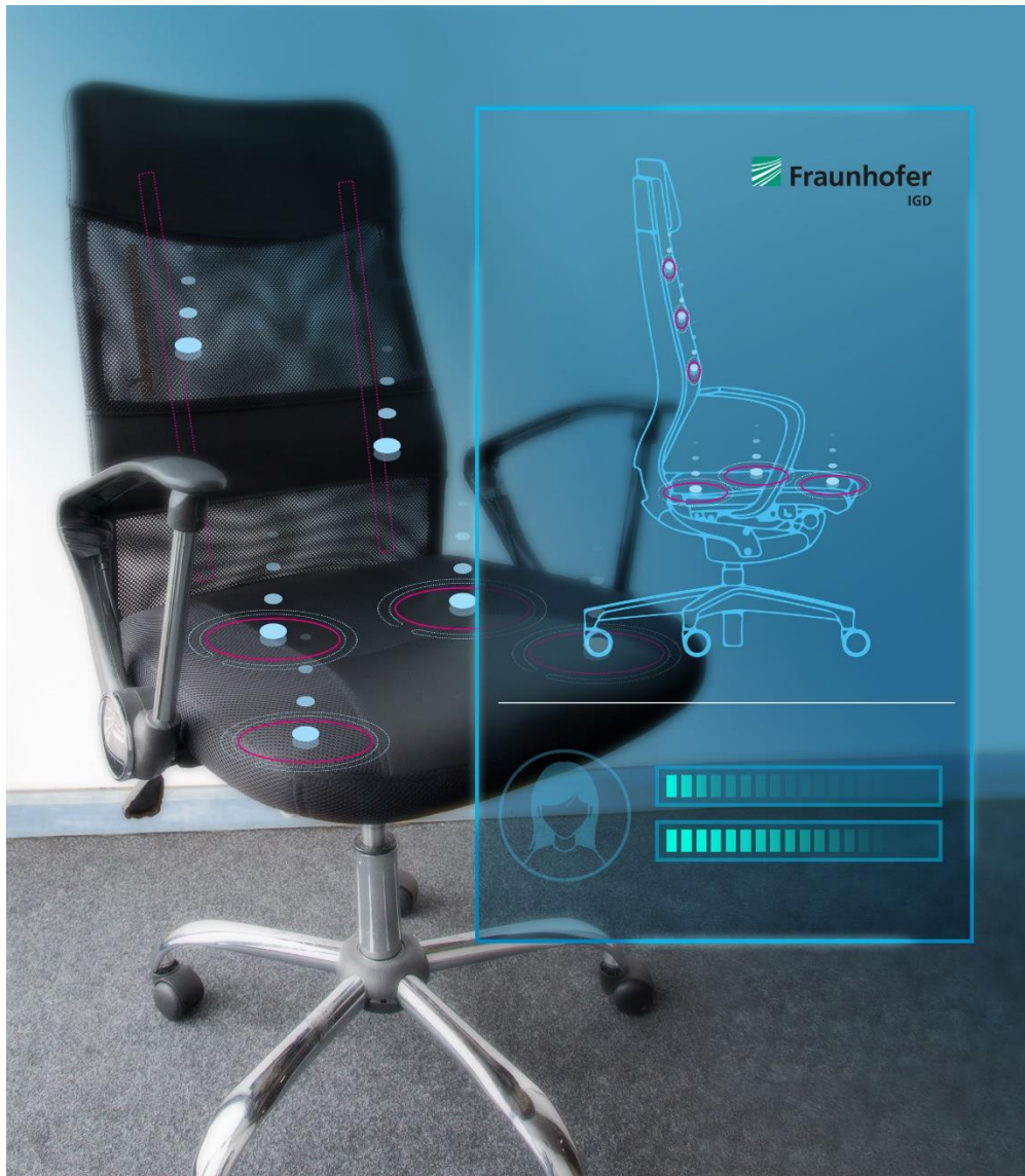
Bild (M): Möbel mit kapazitiven Sensoren tragen zur Gesundheitsüberwachung bei. (© Fraunhofer IGD)
