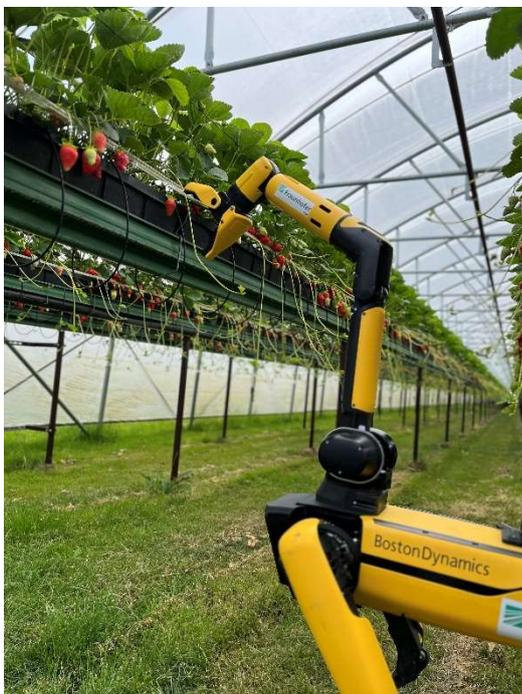
Bild 2: Die Fraunhofer-Institute IGD und IGP entwickeln Robotik zur automatisierten Qualitätskontrolle: Mit Kameras und Sensoren ausgestattete und durch KI-unterstützte Roboter (hier Roboterhund SPOT) können Schädlinge oder Krankheitssymptome an Erdbeerpflanzen erkennen. (© Fraunhofer IGP)
